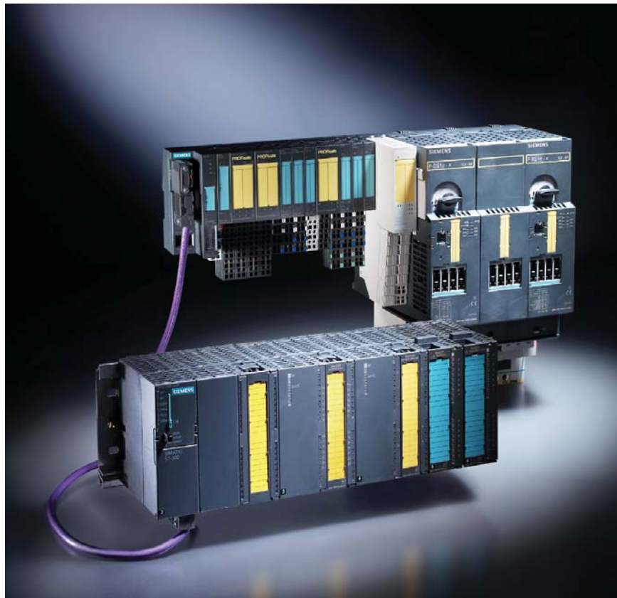
Kombinovaná konfigurace standardních a bezpečnostních modulů, včetně motorových spouštěčů
